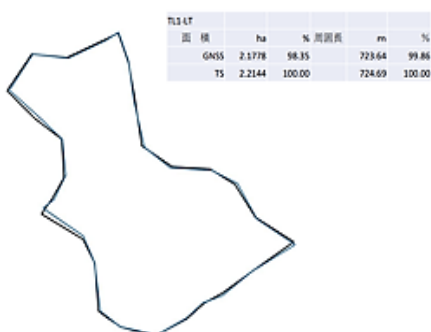
図 4.3.3 2 周波 GNSS TK-1LT 単独・SBAS（青）とトータルステーション測量（黒）の対比
