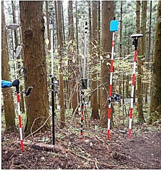
図 1.6 精度検証に用いた GNSS 受信機
