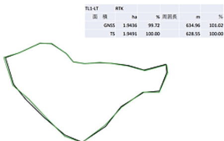
図 4.3.40 2 周波 GNSS TK-1LT RTK (緑) とトータルステーション測量 (黒) の対比
