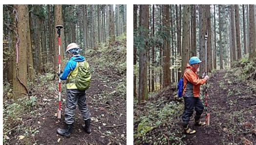
図 1.5 GNSS 受信機による測位 高さ約 2m のポール先端にアンテナを取り付け、各測点で一定時間計測を行う。
