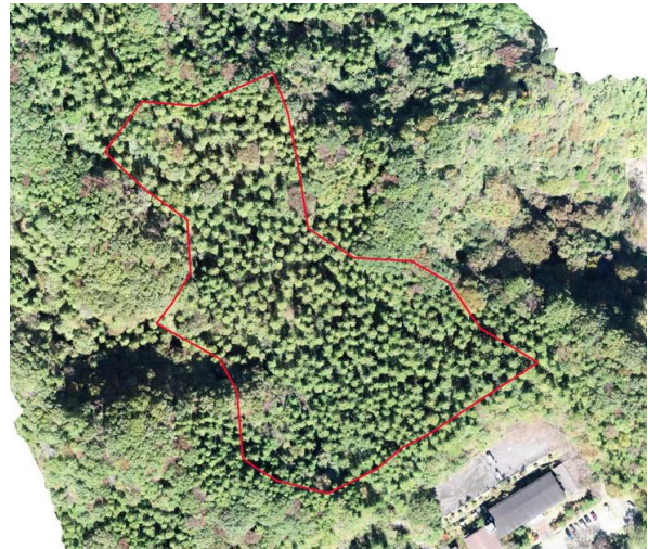
図 2.3 検証地 114 林班の周囲測量 赤枠はトータルステーションによる測量成果
